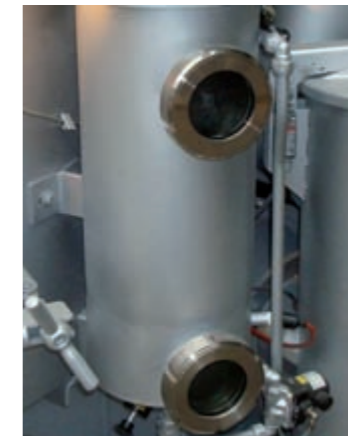
Il separatore d'acqua autopulente non richiede manutenzioni con secondo separatore d'acqua
